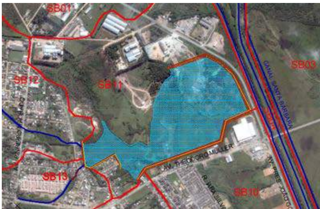
Figura 39: Proposição 1 - Reservatório na cota de coroamento 6,0 m.
