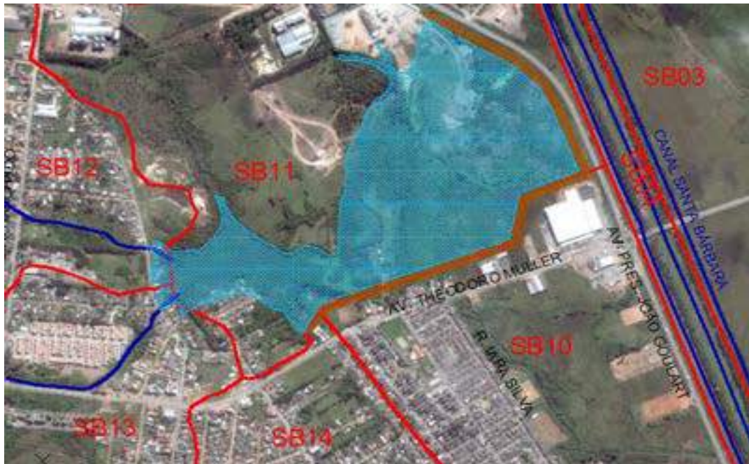
Figura 40: Proposição 2 - Reservatório na cota de coroamento 5,0 m.
