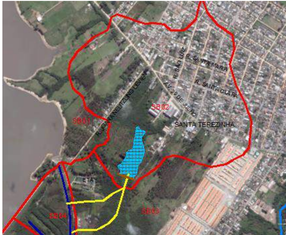
Figura 45: Proposição da Sb-02 com conduto forçado até a Sb-04 (Duas alternativas de traçado).
